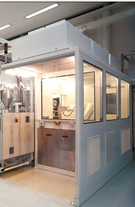
Der Roboter verpackt die Teile bei der Entformung direkt in sterile Beutel.
